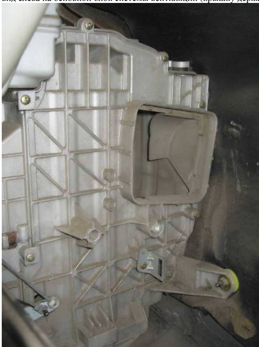
вид слева на основной блок системы вентиляции (крышку держат 8 саморезов)
