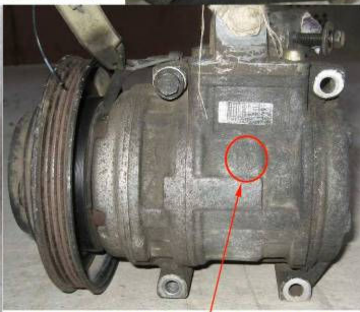
отлив пятнашки на корпусе
